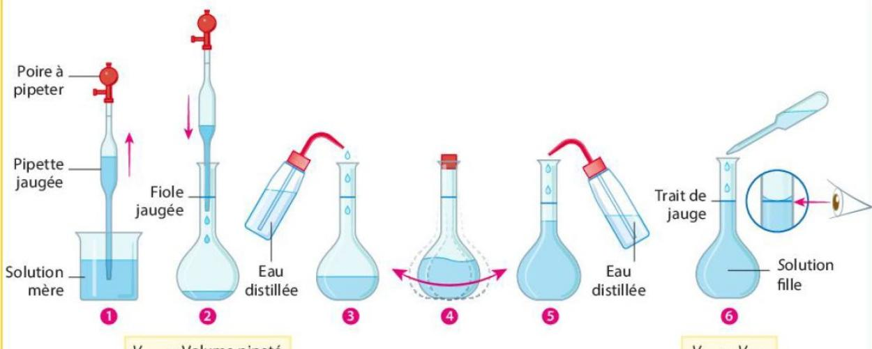
Le volume de solution à prélever par la pipette jaugée est repéré par des traits de jauge.
